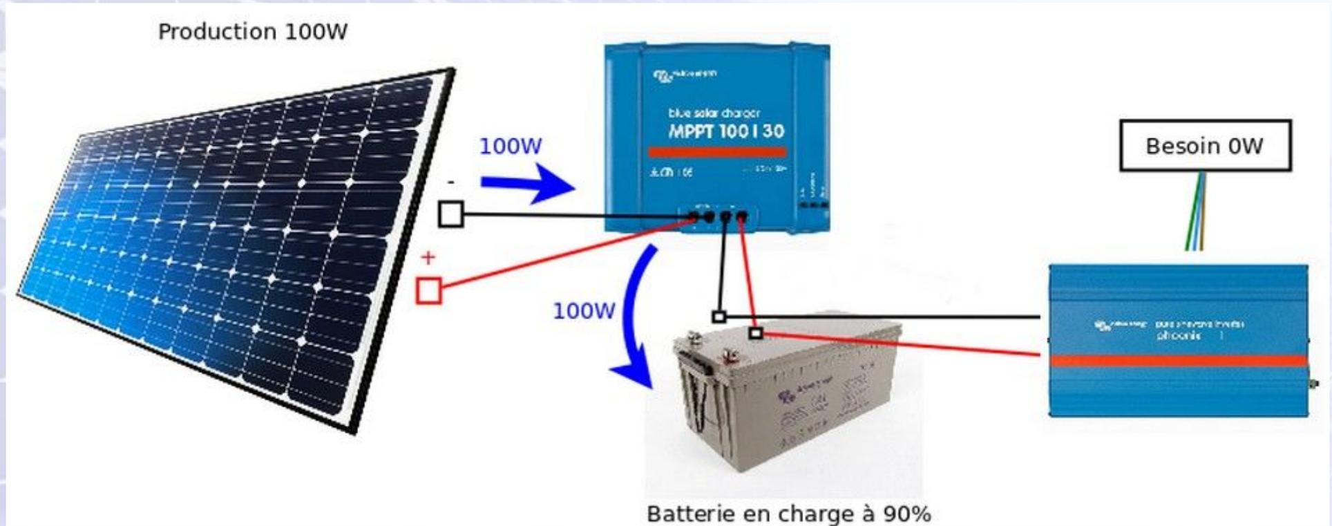
MPPT en mode bulk car niveau de batterie != 100 %
